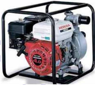
2" Ø de succión por 2" Ø pulgadas de descarga, centrífuga, autocebante, una etapa, de superficie, capacidad máxima de descarga 600 lts/min., altura total 26 mca., altura de succión 8 mts. chasis completo tipo jaula. Incluye Abrazaderas acoples y canastillo de succión.
