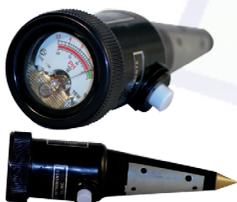
**Medidor de pH y Humedad Kelway**
